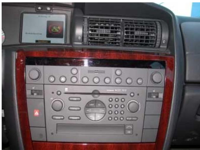
Unübersichtlich präsentiert sich die Mittelkonsole des Omega. Wegen der Gleichförmigkeit der Funktionselemente sind Fehlbedienungen vorprogrammiert.
