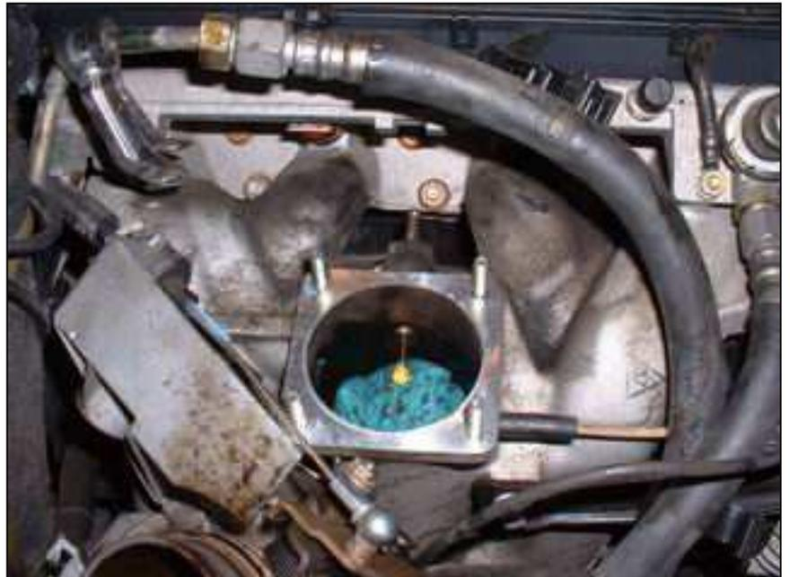
Die **Hohlschraube** nun mit einem nicht mehr als 1,5mm starken Draht (Nagel, dicke Nadel, Schweißdraht, Büroklammer oder ähnliches) **durchstoßen**. Achtung, der Durchmesser der Hohlschraube ist zu ihrer Mitte hin enger! (1,5 mm) - Ein entsprechend vorbereiteter Draht ist bei der *Schnell-Lösung* weiter oben abgebildet.
