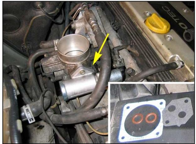
Den Leerlaufsteller herausnehmen und den Teil mit der **Schwingspule** (im Bild rechts) abschrauben. Den Schwingekern und die Führung säubern und einen Tropfen (säurefreies) Nähmaschinen- oder Fahrradöl in die Führung (Spalt) geben.
