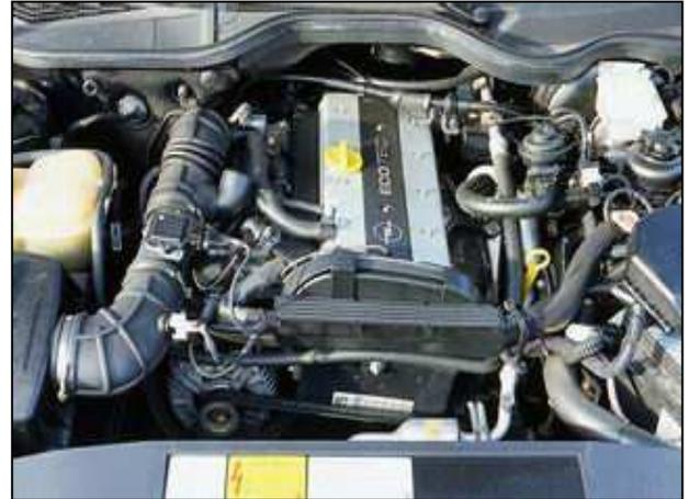
Zuerst die beiden an diesem Rohr befindlichen **Stecker entfernen**. Dazu die Metallklammern an den Steckern drücken.
