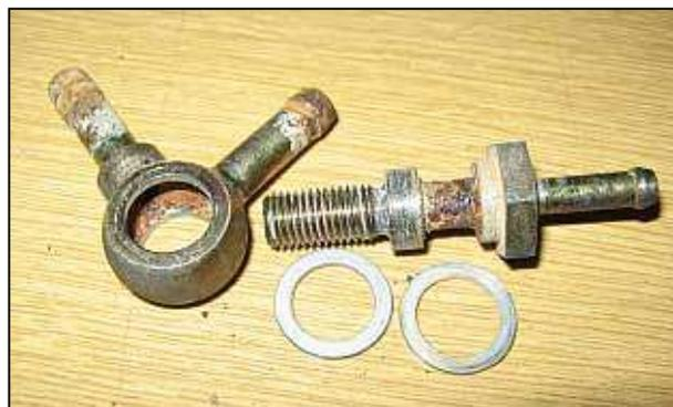
Für einen anhaltend störungsfreien Leerlaufbetrieb kann man alternativ die Hohl-schraube aufbohren (auf 2 mm bis maximal 2,5 mm), wie es Opel-intern praktiziert wird. Diese Maßnahme ist evtl. bei Motoren angebracht, die vorwie-gend im Kurzstreckenbetrieb laufen, eine hohe Laufleistung haben und sehr schwarzes Motoröl.
