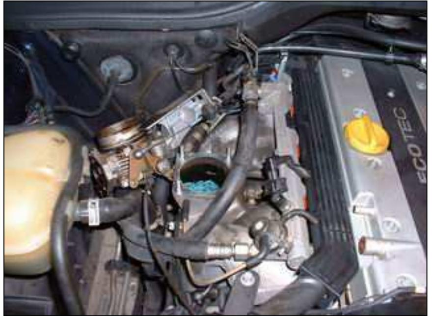
Im offenen Ansaugstutzen kann man einen Teil des Gewindes der **Hohlschraube** sehen (eine Nadel steckt darin). In diese mündet der dünnere der Entlüftungsschläuche (im Bild ist er bereits entfernt). Diese Hohlschraube ist eventuell verstopft!
