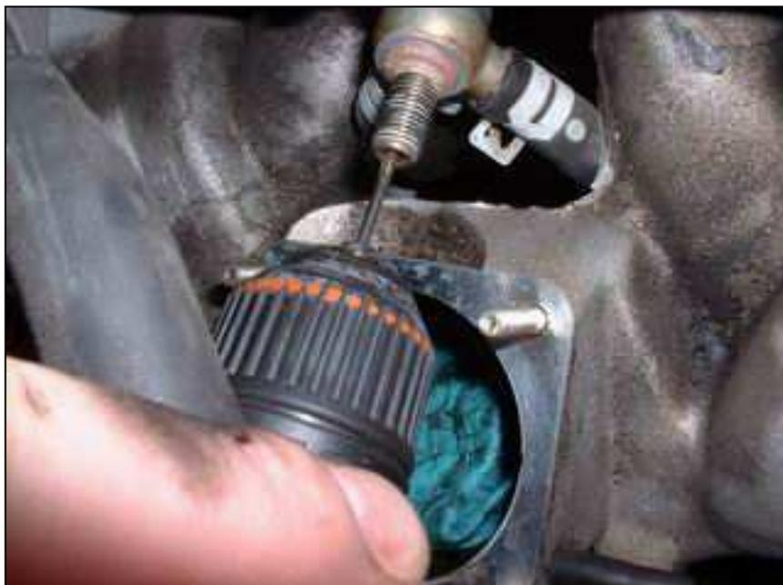
Abschließend die Hohlschraube gründlich säubern: Zum Beseitigen von Späne einen Draht ein paarmal durchstoßen und möglichst noch (mit Pressluft) durchblasen.
