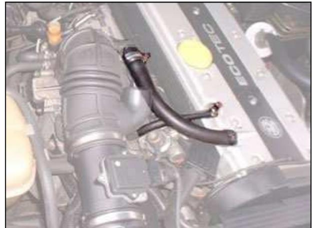
Dann beim **Ansaugluftführungsschlauch** die **Schlauchscheiben** am Drosselklappengehäuse und am Luftfilterkasten mit dem Schraubendreher weit genug lösen und das Plastikrohr entfernen.
