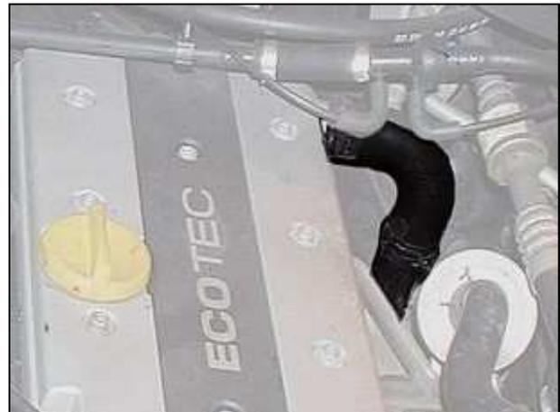
In den anderen aufgeführten Opel-Modellen sind Abgaskrümmer und Kurbelgehäuseentlüftungsrrohr dem Fahrtwind mehr ausgesetzt und somit gut gekühlt, weshalb der Ölabscheider hier problemlos funktioniert.
