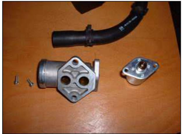
Wem der Drosselklappen-Reiniger von Liqui Moly (15 €) für ein „Vollbad“ des Leerlaufreglers zu kostbar ist, kann wie ich die beiden Löcher des LLR, durch die man das Ventil sieht, mit Klebeband zukleben, den senkrecht hingestellten LLR mit dem Reiniger füllen und diesen eine Stunde oder länger einwirken lassen. Danach den LLR entleeren, das Klebeband entfernen und mit einem Pinsel nachwischen. Abschließend ausspülen (z.B. mit Waschbenzin) und auf gründliche Sauberkeit prüfen.
